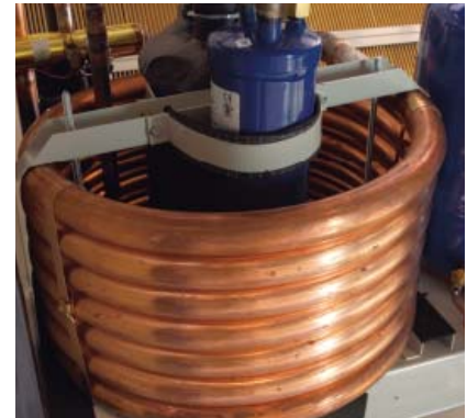
Skraplacz chłodzony wodą umożliwia przekazanie nadmiaru ciepła, np. w celu podgrzania wody w basenie lub ciepłej wody użytkowej.
