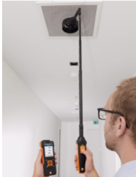
Pomiary na sufitowych kratkach wentylacyjnych bez konieczności użycia drabiny. Po prostu podłącz sondę wiatraczkową (Ø 100 mm) do teleskopu i przejściówki kątowej 90°.
