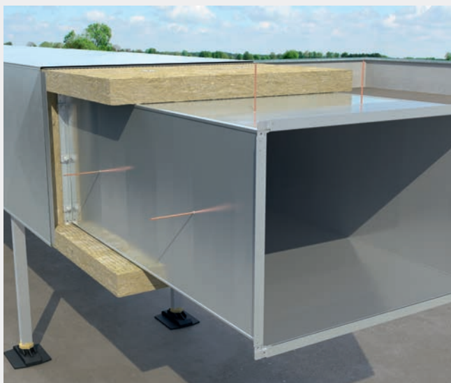
WIZ. 416.3. Mocowanie arkuszy stalowej blachy ocynkowanej jako płaszcza zewnętrznego.
